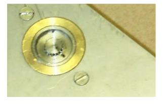
STEP 5 MARK POSITION OF END CAP ON SPLINED SHAFT.
